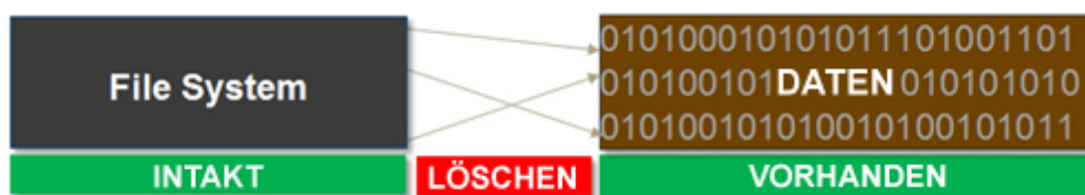
Schaubild 1 – Einfache Datenlöschung löscht nur das Verzeichnis, nicht die Daten selbst
