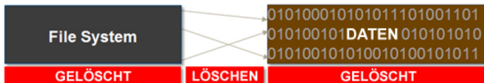
Schaubild 2 – Die sichere Datenlöschung löscht das Verzeichnis sowie die Daten selbst
